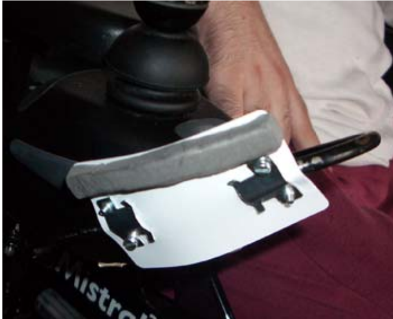
Vista de detalle desde abajo del anclaje de la adaptación al aro protector del mando de la silla.
