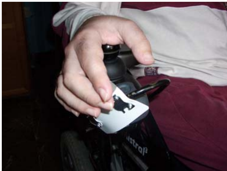
Vista frontal de la adaptación de tarjeta acolchada con la mano en posición.
